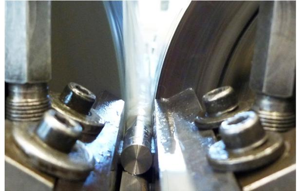
**Centerlesschleifen** Ø 1,5 – 35,0 mm
