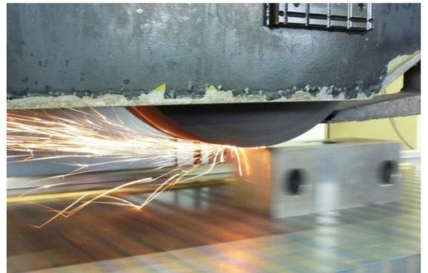
**Flachschleifen** Magnettisch, 600 x 250 mm.
