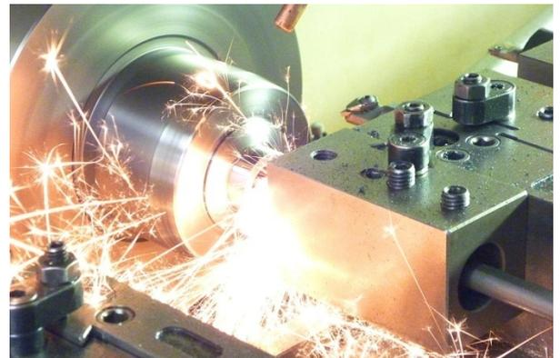
**Hartdrehen** Auf CNC Maschinen, bis 65 HRC.
