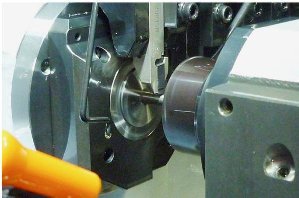
**Langdrehen**  $\varnothing$  1,0 – 32,0 mm ab Stange, Anzahl Achsen: 7, CNC-Maschinen mit angetriebenen Werkzeugen und Tieflochbohren ab  $\varnothing$  0,2 mm.
