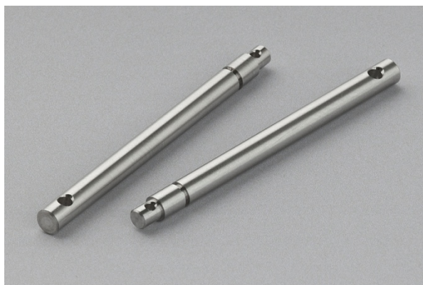
Achse D: Ø 3js6 x 40 / M: 1.4305
