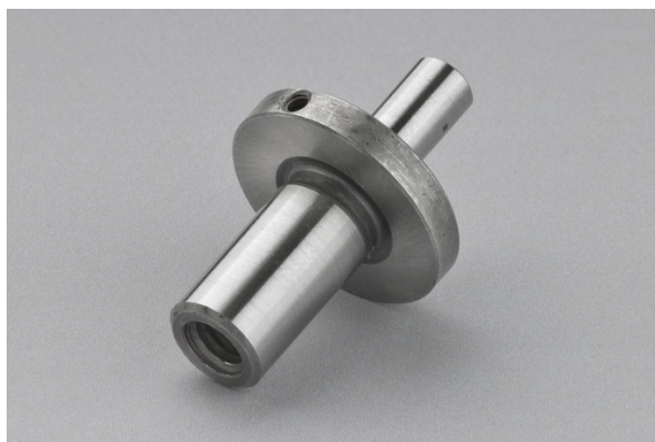
Arbor D: \varnothing 8_{js5} \times 29 / M: 1.2510
